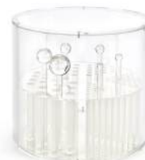
Phantom kiểm tra chất lượng hình ảnh hệ thống chụp cắt lớp xạ đơn photon (SPECT)
