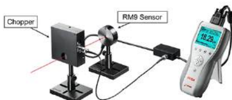
Bộ thiết bị kiểm tra, phân tích công suất laser trị liệu
