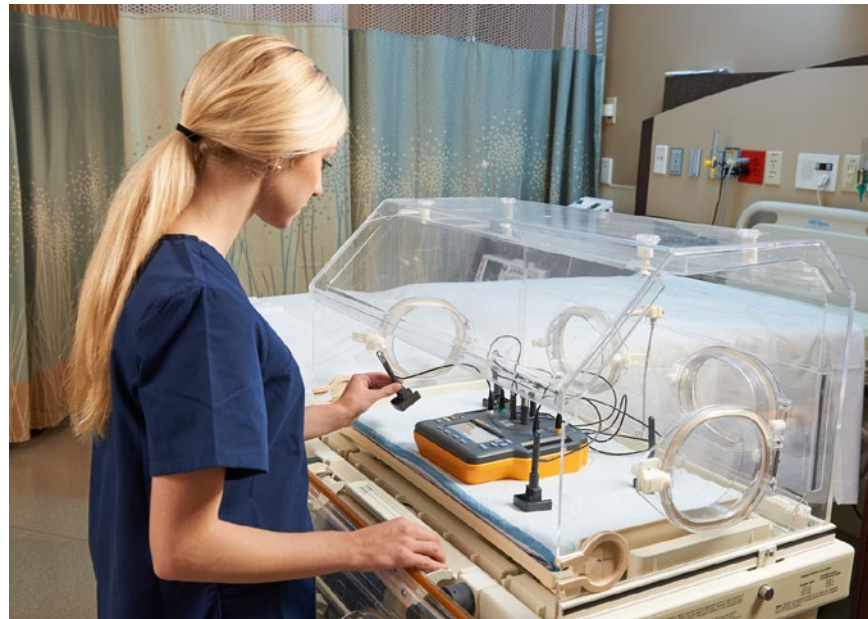
Thiết bị phân tích lồng ấp trẻ sơ sinh/Máy phân tích nhiệt độ bức xạ INCU II đang được sử dụng để kiểm tra lồng ấp trẻ sơ sinh
